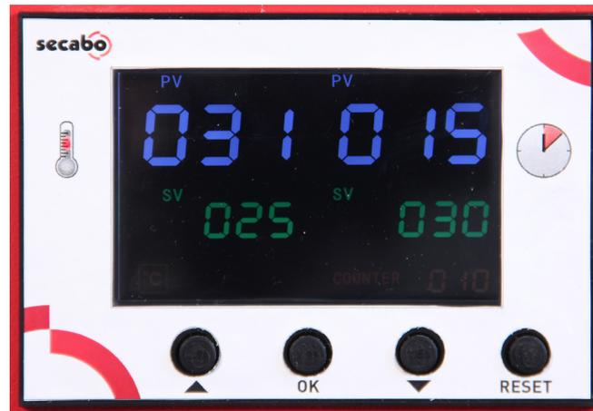
Der zentrale Controller verfügt über Einstellmöglichkeiten für die gewünschte Temperatur ( $^{\circ}\text{C}$  und  $^{\circ}\text{F}$ ) sowie die Pressdauer in Sekunden. Die grünen Ziffern stellen die Soll-Werte da, während die weißen Ziffern die aktuellen Ist-Werte wiedergeben. Unten rechts wird der Counter angezeigt, der die durchgeführten Pressvorgänge seit dem letzten Reset angibt.
