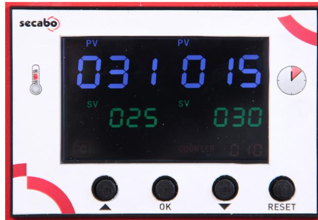
Der zentrale Controller verfügt über Einstellmöglichkeiten für die gewünschte Temperatur (°C und °F) sowie die Pressdauer in Sekunden. Die grünen Ziffern stellen die Soll-Werte da, während die weißen Ziffern die aktuellen Ist-Werte wiedergeben. Unten rechts wird der Counter angezeigt, der die durchgeführten Pressvorgänge seit dem letzten Reset angibt.
