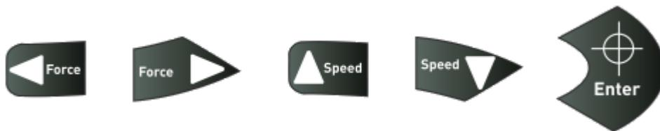
Pour la mise en place du point d'origine, appuyez sur Online puis déplacez le chariot à l'aide des touches appuyez sur « Enter » pour valider le point d'origine, après le plotter se met automatiquement en mode Online.
