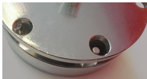
Hinweis: Nach längerem Gebrauch der Buttonmaschine kann es zu einer Verstellung der hinteren Anschläge kommen, diese können mittels Kreuzschlitzschraubenzieher ggf. nachjustiert werden.
