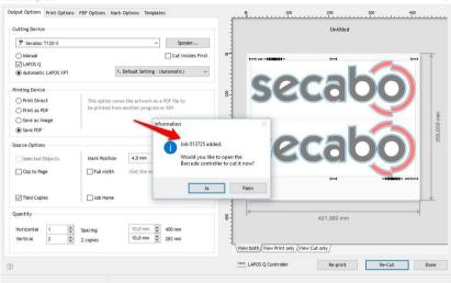
• Öffnen Sie den "Lapos Q Controller" im Vinylspooler.
