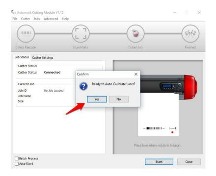
Der Plotter führt nun die Kalibrierung automatisch durch und meldet sich mit dem für Ihr Gerät korrekten Laser-Versatz zurück, den Sie mit einem Klick auf "OK" noch bestätigen müssen.
