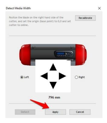
Anschließend wird die gemessene Breite als Medienbreite im Vinylspooler hinterlegt.
