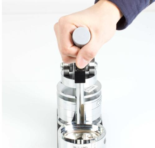
**Advertencia:** tras un uso prolongado de la máquina puede que los pivotes traseros de los cilindros inferiores se desregulen, teniendo que ser de nuevo ajustados, con un destornillador para el correcto funcionamiento de la máquina.
