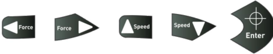
Im Offline-Modus kann der Messerkopf durch Drücken der Pfeiltasten „Force“ nach rechts und links bewegt werden, sowie vorwärts und rückwärts mit Hilfe der „Speed“ Pfeiltasten. Im Display sind die entsprechenden X und Y Koordinaten zu sehen.
