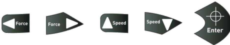
Um den korrekten Ausgangspunkt zum Plotten zu setzen, bewegen Sie im Offline-Modus den Messerkopf und die Folie so, dass sich der Laser-Punkt in der so genannten Start-Box vor dem Barcode auf dem eingelegten Medium befindet. Bestätigen Sie nun diesen Nullpunkt durch Drücken des Fadenkreuzes, dadurch wechselt das Gerät auch automatisch in den Online-Modus.
