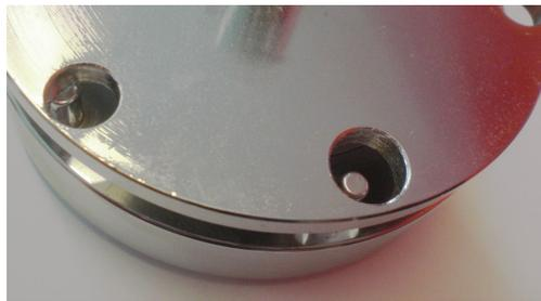
Indication : Après une longue utilisation de la machine de boutons on pourrait éventuellement remarquer un déplacement des arrêts postérieurs qu'on peut ajuster avec un tournevis cruciforme.
